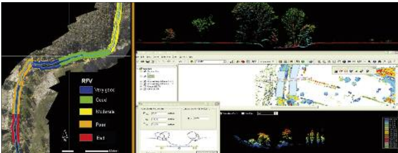
Fig.5.- Interfaz gráfica de la aplicación RiC-DAR. La aplicación permite, a partir de datos LiDAR, la caracterización morfológica de los cauces y la valoración del estado del bosque de ribera, mapeando con colores el estado de los diferentes tramos
