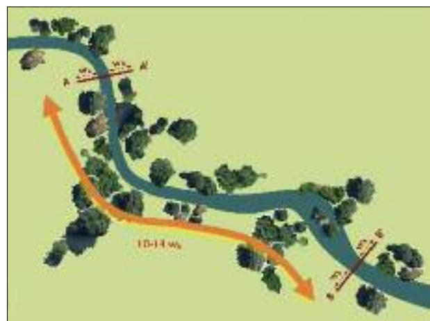
Fig.4.- Delimitación de la zona de estudio en la aplicación del índice RFV. El índice liga la zona de muestreo con una variable morfológica del río, la anchura de bankfull (wb), permitiendo de este modo dimensionar la zona de estudio en función del tamaño del propio río
